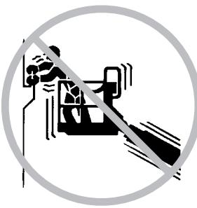
没有制造商事先书面许可，不要修改或改动工作平台的空中部分。在平台、脚踏板或护栏上安装用于放置工具或其它材料的附加装置，会加大平台重量和平台表面面积或者加大负载。
