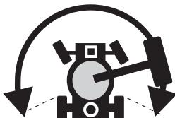
要驱动机器，请推进驱动启用按钮，并缓慢移动驱动/转向控制手柄，使它离开中心位置。
