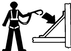
平台上的人员必须佩带安全带或使用符合政府规章的安全设施。将系索系在平台的固定点上。
