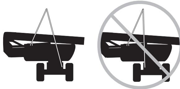
只能将索具连接到离转盘提升点最远的两个底盘提升点上。
